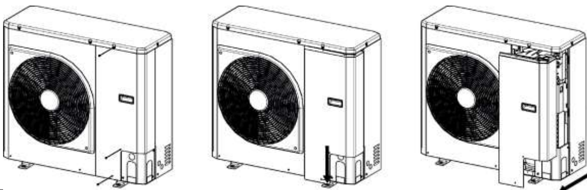
Фигура 4: Сваляне на предния панел за уреди с мощност 5 и 7 kW
